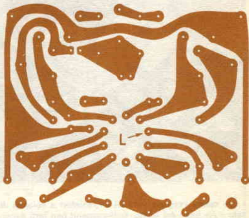
Fig. 3 - Circuito stampato in grandezza naturale e disposizione dei componenti dell'amplificatore 540.
